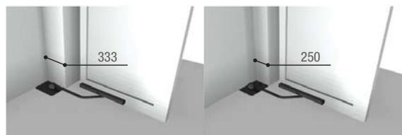
Moteur enterré en position standard. Moteur enterré en position latérale (pour encombrements réduits).
