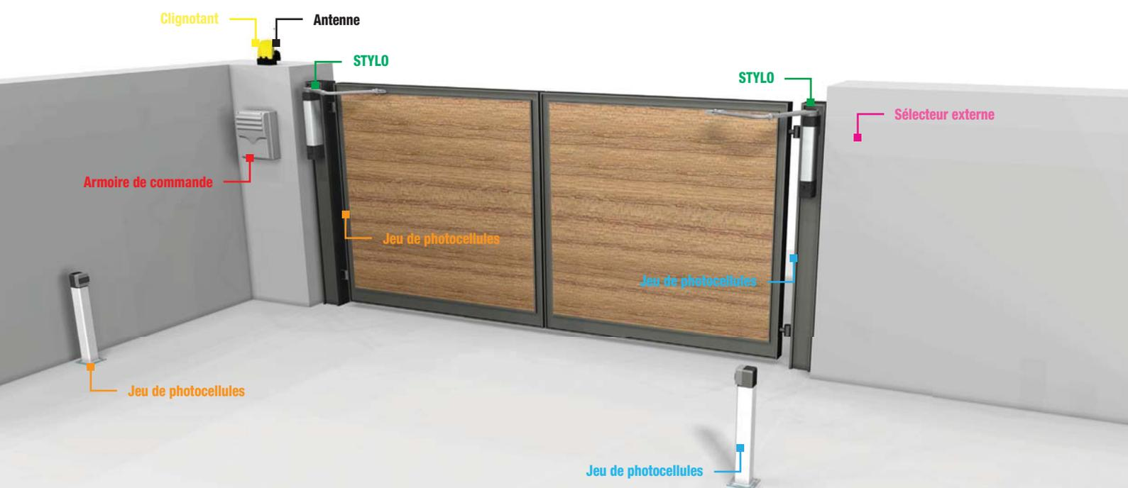
Typologie de câblage - ● 230 V AC ● 2 x 0,5 mm<sup>2</sup> ● 4 x 0,5 mm<sup>2</sup> ● 3 x 1,5 mm<sup>2</sup> ● 3 x 0,5 mm<sup>2</sup> ● 1 x 1,5 mm<sup>2</sup> ● RG58
