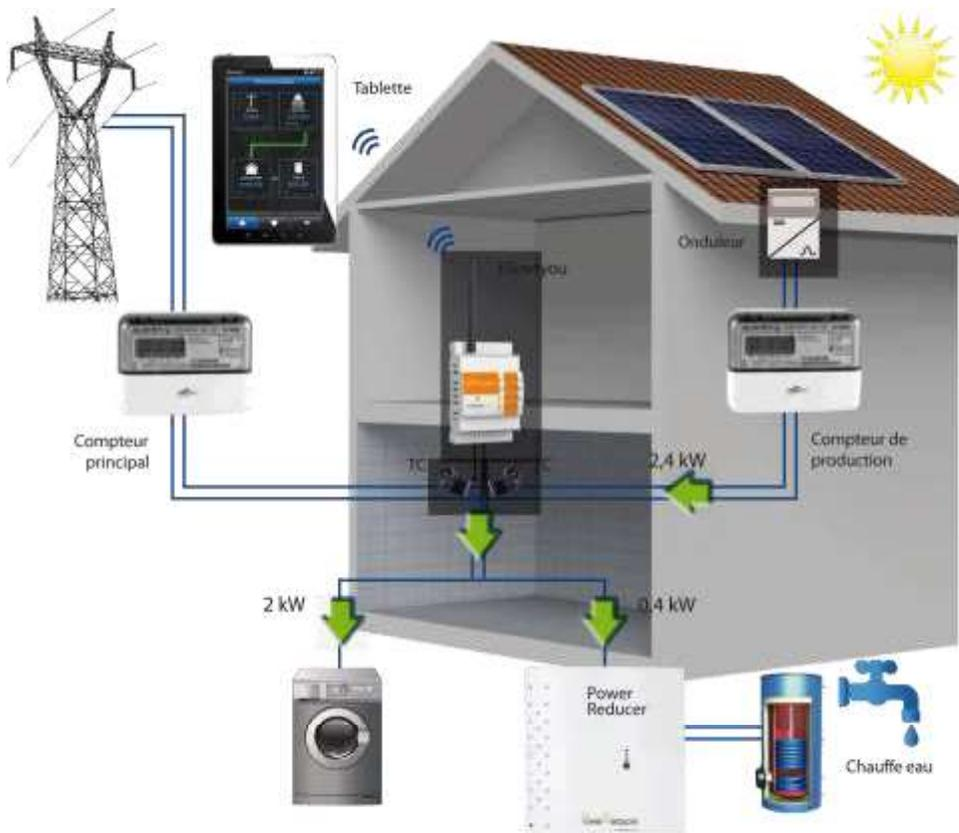
*Elios4you permet de tirer avantage de l'excédent de production pour alimenter l'appareillage électrique du domicile (machine à laver, prises électriques...), et la production d'eau chaude via le module Power reducer.*
